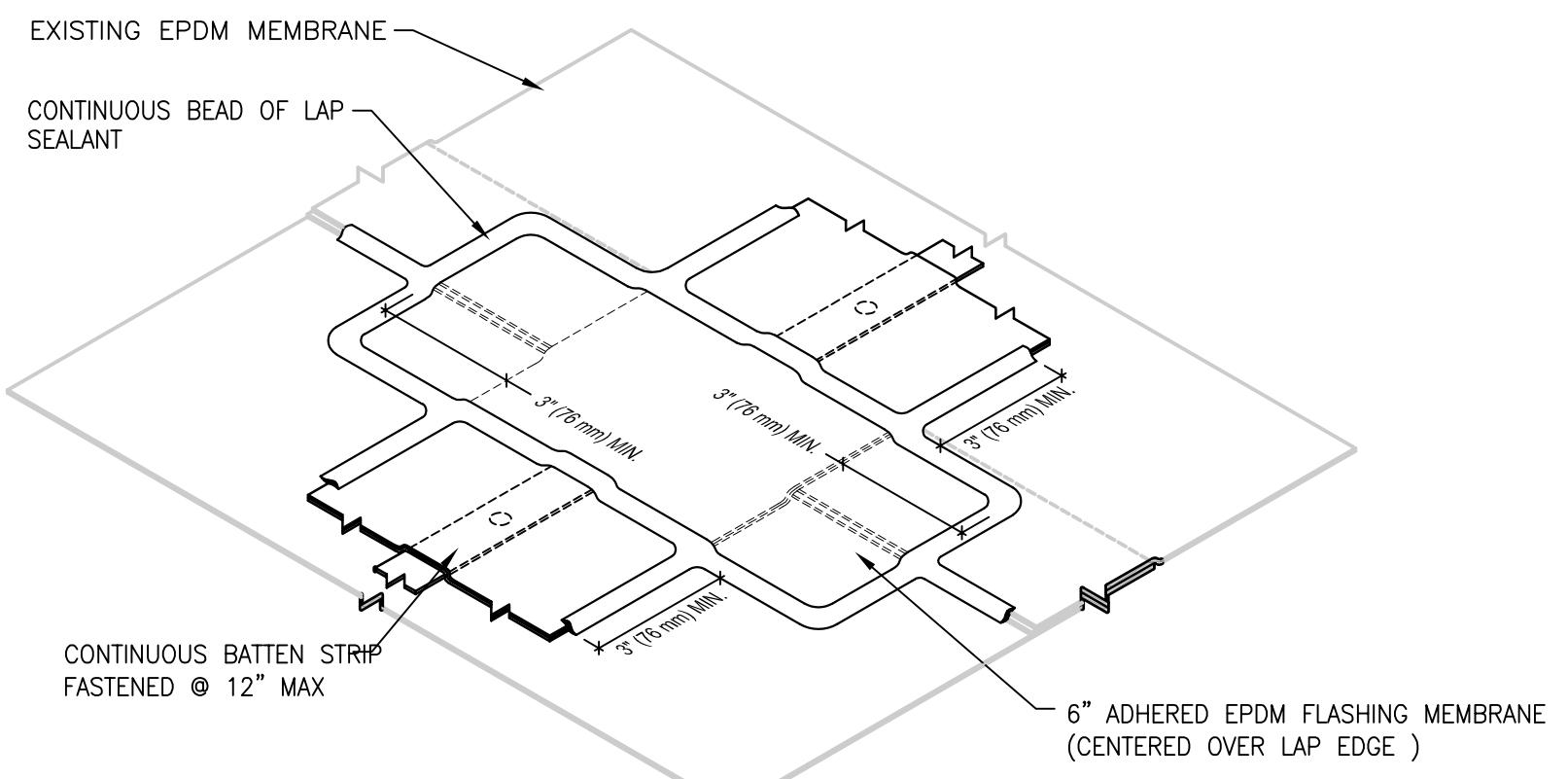
TYPICAL BATTEN SPLICE AT MEMBRANE LAP
