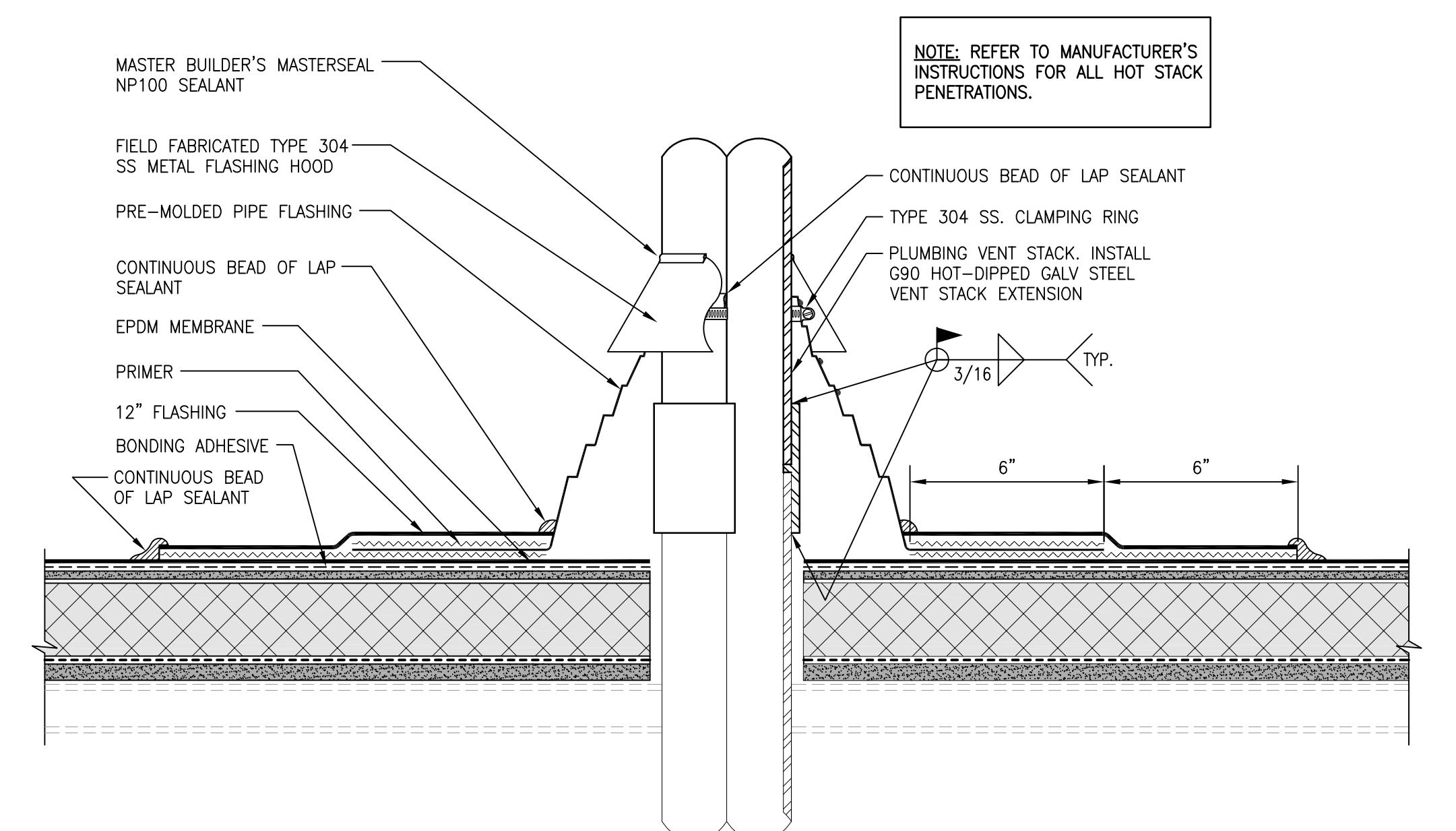
TYPICAL PIPE PENETRATION DETAIL
