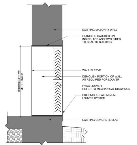
7 TYPICAL LOUVER SILL DETAIL IN EXISTING WALL
