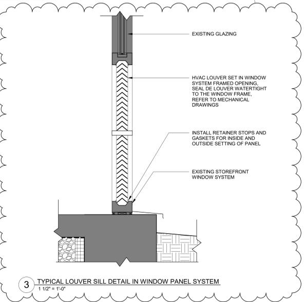
3 TYPICAL LOUVER SILL DETAIL IN WINDOW PANEL SYSTEM
