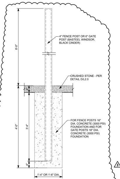
**MECHANICAL COURTYARD FENCE/GATE POST FOUNDATION - DETAIL N**
